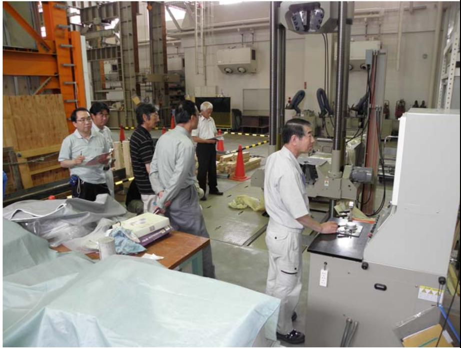
圧縮試験終了後割裂して中性化試験
